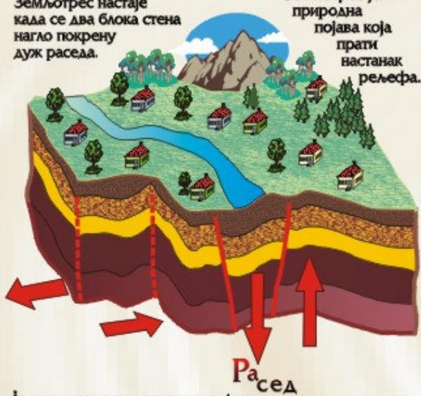
Је уска зона смрвљеног материјала која лежи између два блока стена као шав.
