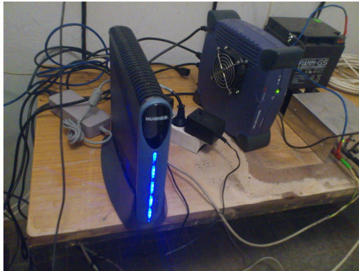
Slika 24. Satelitski modem sa uređajem za stalno napajanje
