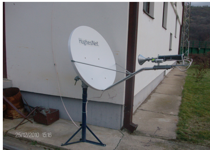
Slika 25. Spoljna jedinica satelitskog prenosa signala
